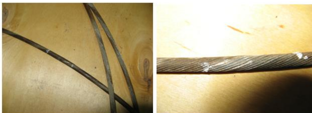
а) загальний вигляд; б) жила броні кабеля, зміцнена скобами
