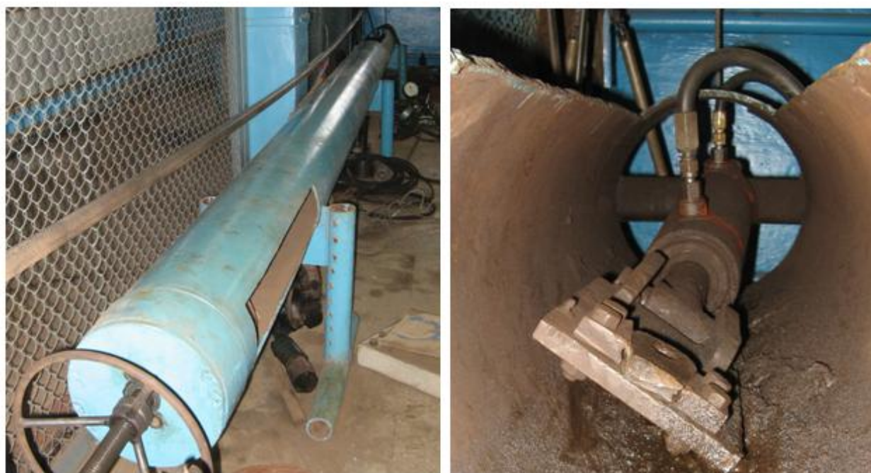
а) загальний вигляд; б) навантажувальний вузол (гідроциліндр)
