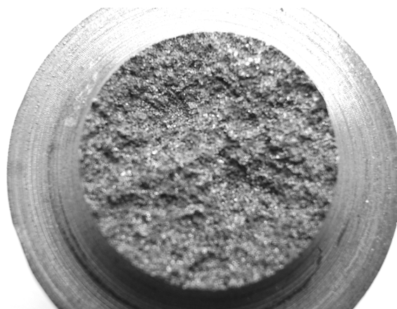
Рисунок 4 – Зовнішній вигляд форми зламу зразка
