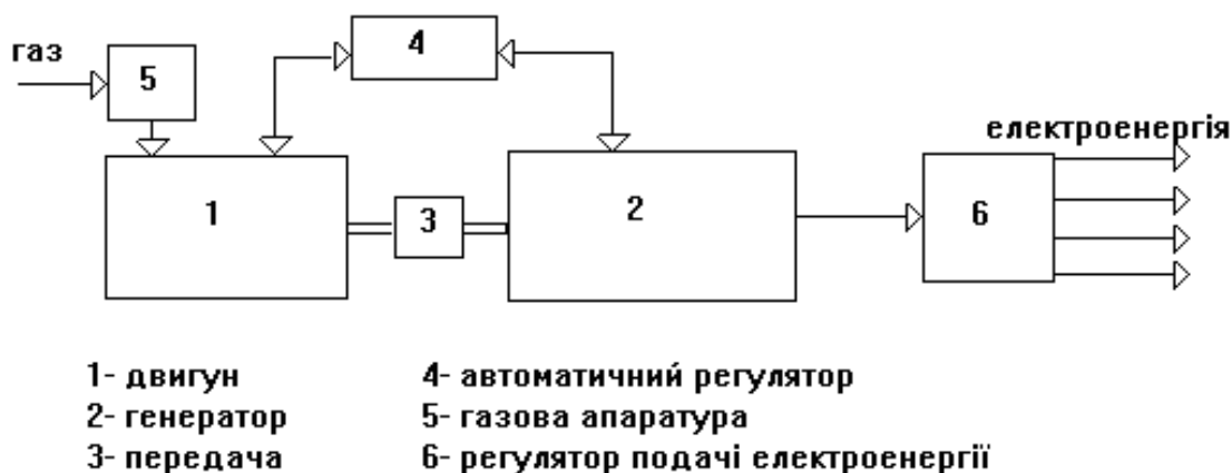
Рисунок 4.1 – Схема установки утилізації викидів горючих газів
