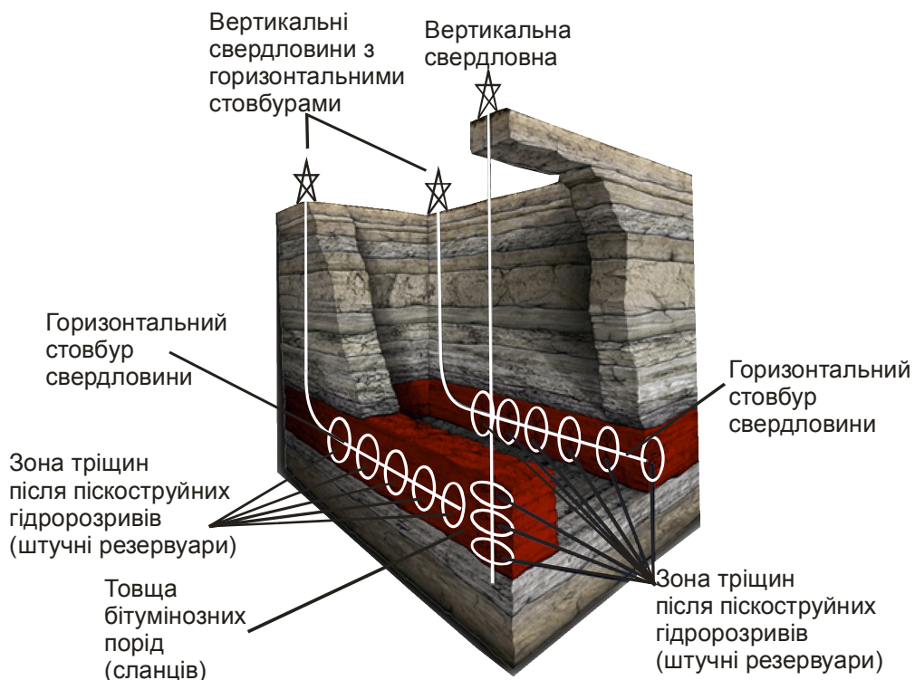
Рисунок 9.2 Блок-діаграма видобування сланцевого газу з бітумінозних порід (за http://energyfuture.ru/mestorozhdenie-slancevogo-gaza-plej-play-vudford-woodford-ssha/w3 ).
