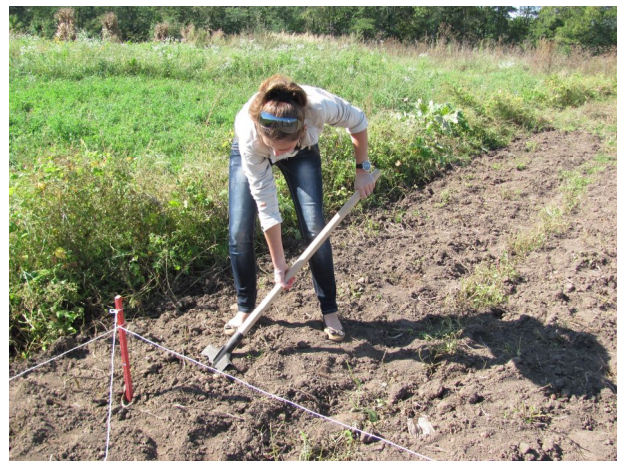
Рис. 8.12. Підготовка ґрунту до відбору проби
