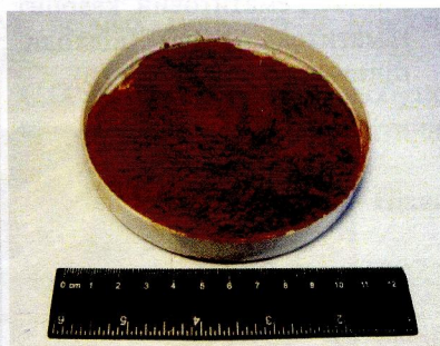
Рис. 4. Продукти сепарації гематитових кварцитів і не кондиційних руд: а - гематитовий концентрат; б – пилоподібні відходи збагачення.
