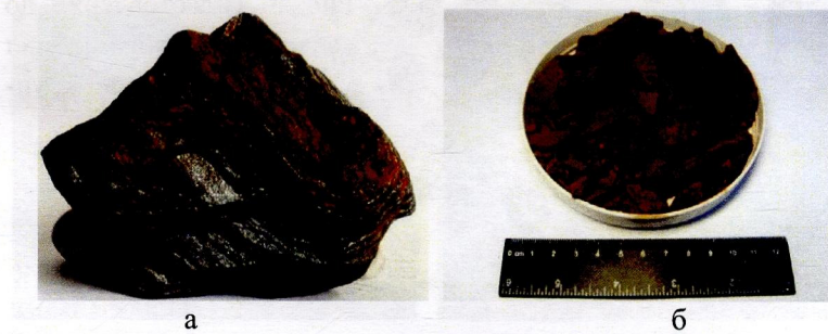
Рис 1. Гематитовий кварцит, без збільшення (а); некондиційна гематитова руда (відходи дробарно-сортувальної фабрики) підземного видобутку (б).
