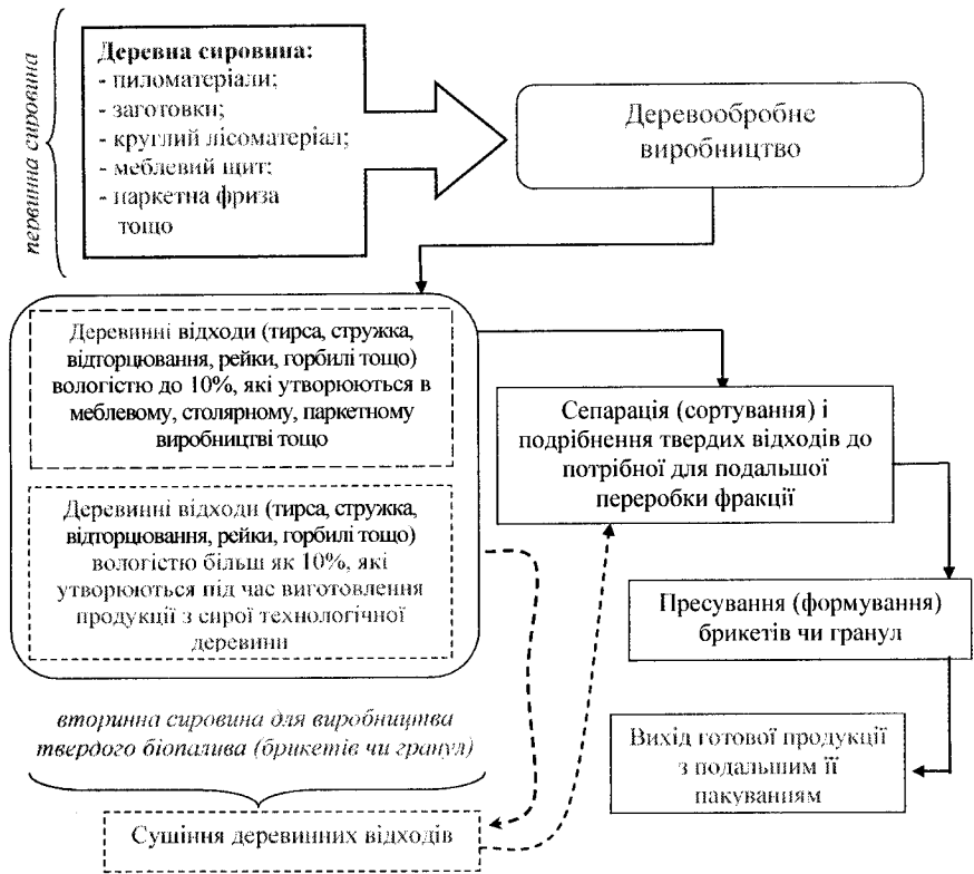
Рис. 1.4. Узагальнена схема комплексного використання деревної сировини деревообробними підприємствами (утворення, переробка та використання деревинних відходів) на виробництво твердого біопалива
