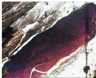
Включення автохтонного вугілля в аргіліті, св. Делятин-15, інт. 4771–4776 м, 40 x
