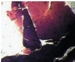
Вугілля з автохтонного включення в пісковуку, св. Південний Монасти- рець-5, інт 4964–4969 м, 40 x
