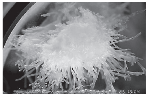
Рис. 61. Масивний кристалогідрат метану, що сформувався на вільному контакті газ-вода (9,8 МПа, 12\text{ }^{\circ}\text{C} ) (а) і масивні кристали гідрату метану, що утворилися в газовому середовищі із водяної пари (8,6 МПа, 3,3\text{ }^{\circ}\text{C} ) (б) (за Ю.Ф. Макогоном, 2003)
