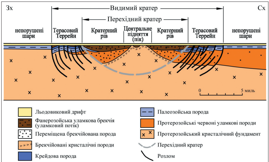
Рис. 77. Схематичний геологічний розріз імпаکتної структури Менсон [413]
