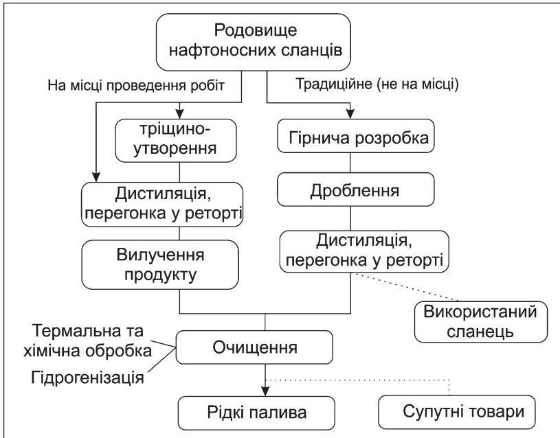
Рис. 44. Принципи виробництва нафти із нафтоносного сланцю
