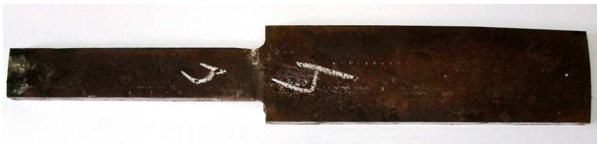
Рисунок 7.7 – Загальний вигляд зразка для випробувань на втомну міцність
