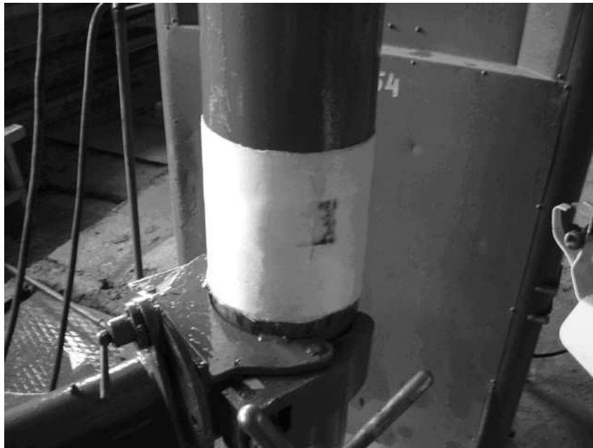
Рисунок 9.18 – Стан бандажу після випробовувань балона з намотаним полімерно-композитним бандажем при одночасній дії згинаючих навантажень і внутрішнього тиску
