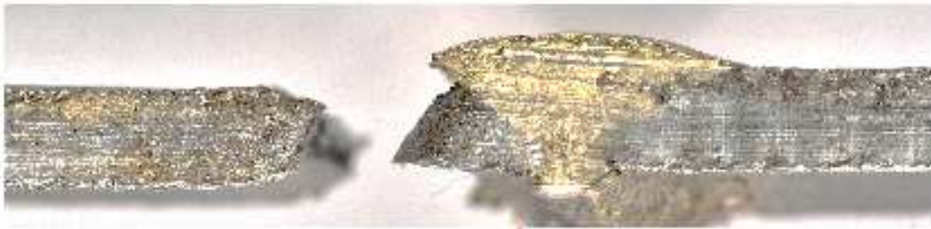
Рисунок 5 – Зруйноване з'єднання труб
