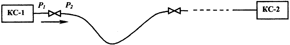
Рисунок 3 — Схема проведення очищення газопроводу методом швидкісних потоків
