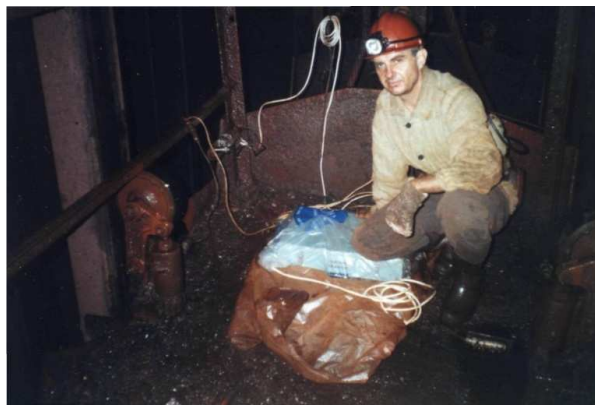
Рисунок 7 - Инструментальный контроль мобильной системой контроля закончен, впереди демонтаж аппаратуры МСК с подъемного сосуда, обработка полученных результатов и всесторонний анализ результатов контроля. Концерн горнорудных и нерудных компаний Украины "Укррудпром"
