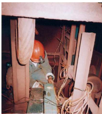
Рисунок 5 - Опробование нового способа контроля скипа МСК на шахте "Эксплуатационная" ЗАО «Запорожского железорудного комбината» (г. Днепропрудное) для определения достаточной чувствительности модели
