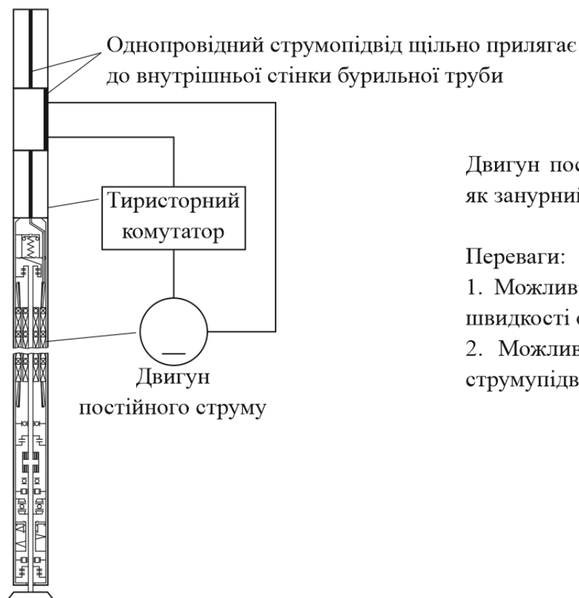
Рис. 1.14. Електробур постійного струму (в майбутньому)
