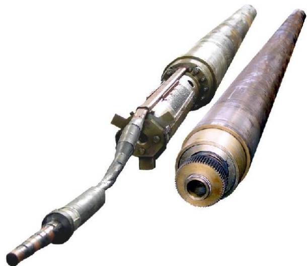
Рис. 1.7. Конструкція електродвигуна електробура і схема його живлення «два проводи – труба»
