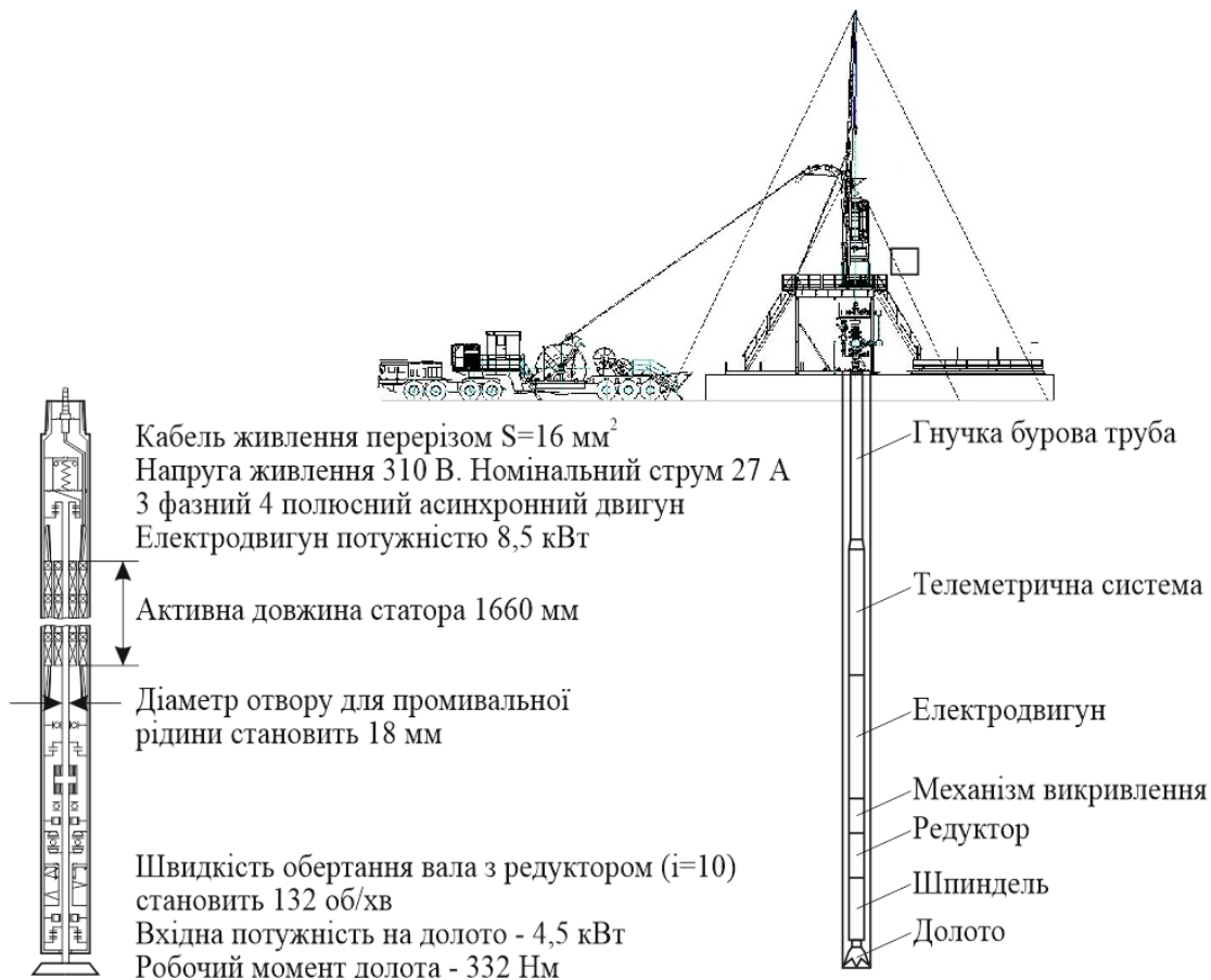
Рис. 1.4. Приклад колтюбінгової бурової установки з діаметром труби 106 мм
