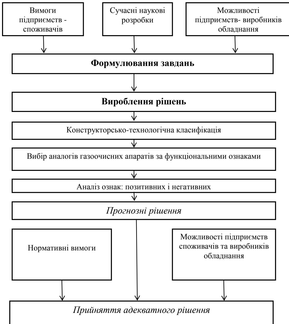
Рисунок 4.7 – Стадії процесу розробки та вибору газоочисного обладнання
