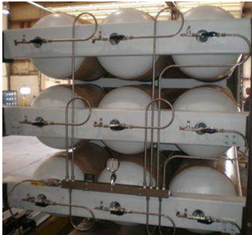
Рисунок 3.20 – Модуль для транспортування стиснутого природного газу, укомплектований балонами типу CNG-2
