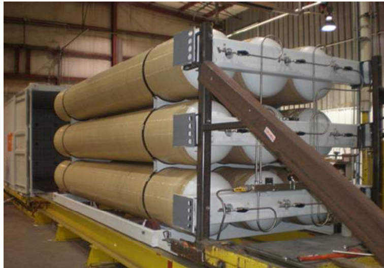
Рисунок 1.17 – Модуль KGTМ, розроблений на базі балонів типу CNG-2
