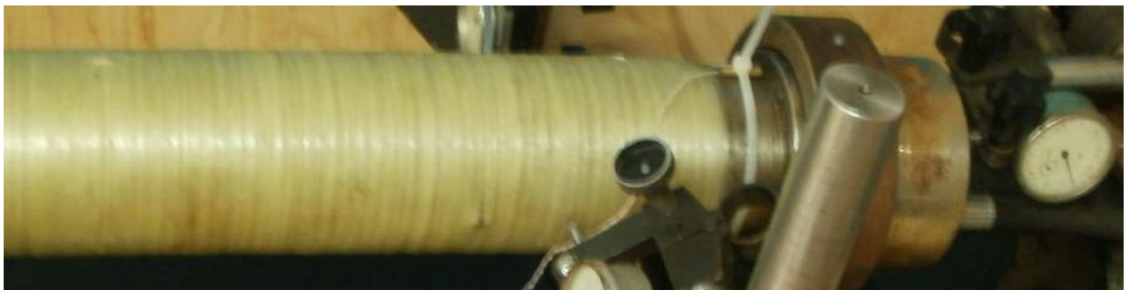
Рисунок 5.8 – Поверхня композитного підсилення із кільцевими тріщинами
