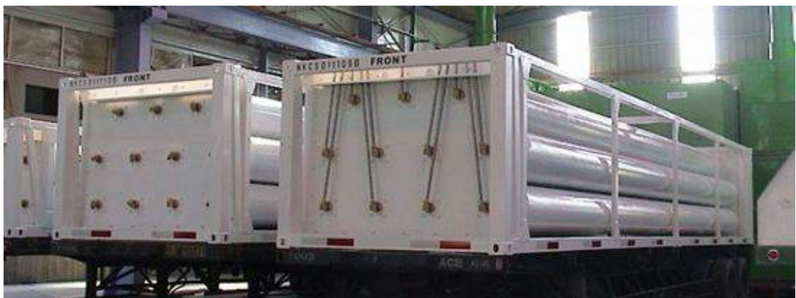
Рисунок 1.18 – Модулі на базі балонів типу CNG-1
