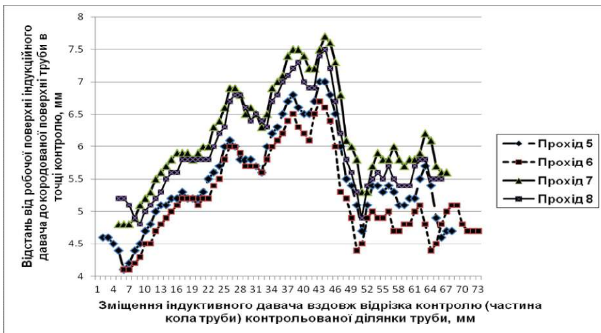
Рисунок 7.7 – Графіки зміни відстані між робочою поверхнею індуктивного давача та кородованою поверхнею металу труби на контрольованій ділянці при почерговому виконанні проходів вдовж ділянки зі зміщенням між проходками 2 мм
