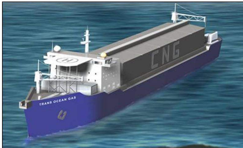
Рисунок 1.15 – CNG судно з газовими транспортними модулями укомплектоване за технологією компанії Trans Ocean Gas
