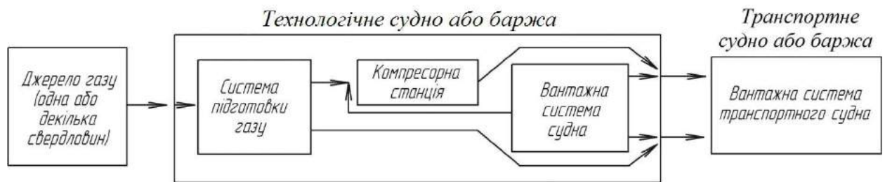
Рисунок 3.9 – Схема реалізації процесу завантаження транспортного судна
