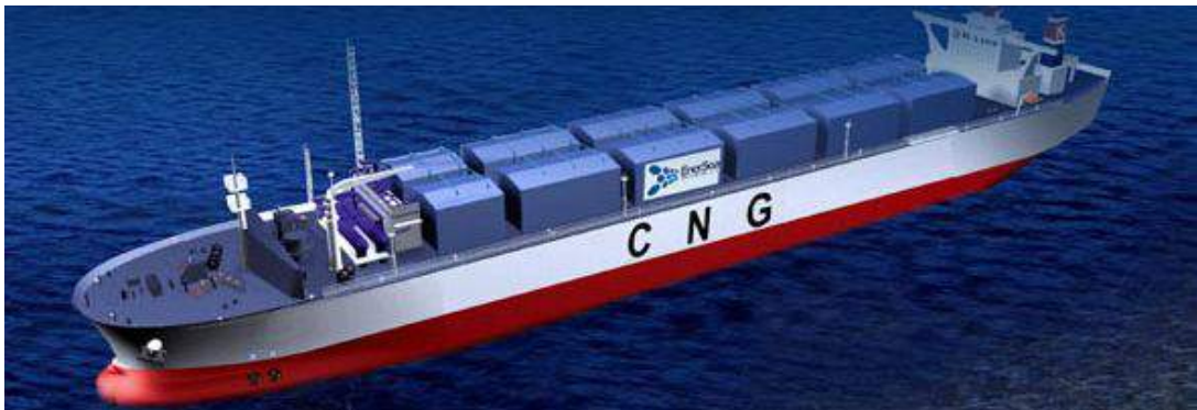
Рисунок 1.9 – CNG судно за технологією компанії EnerSea Transport LLC
