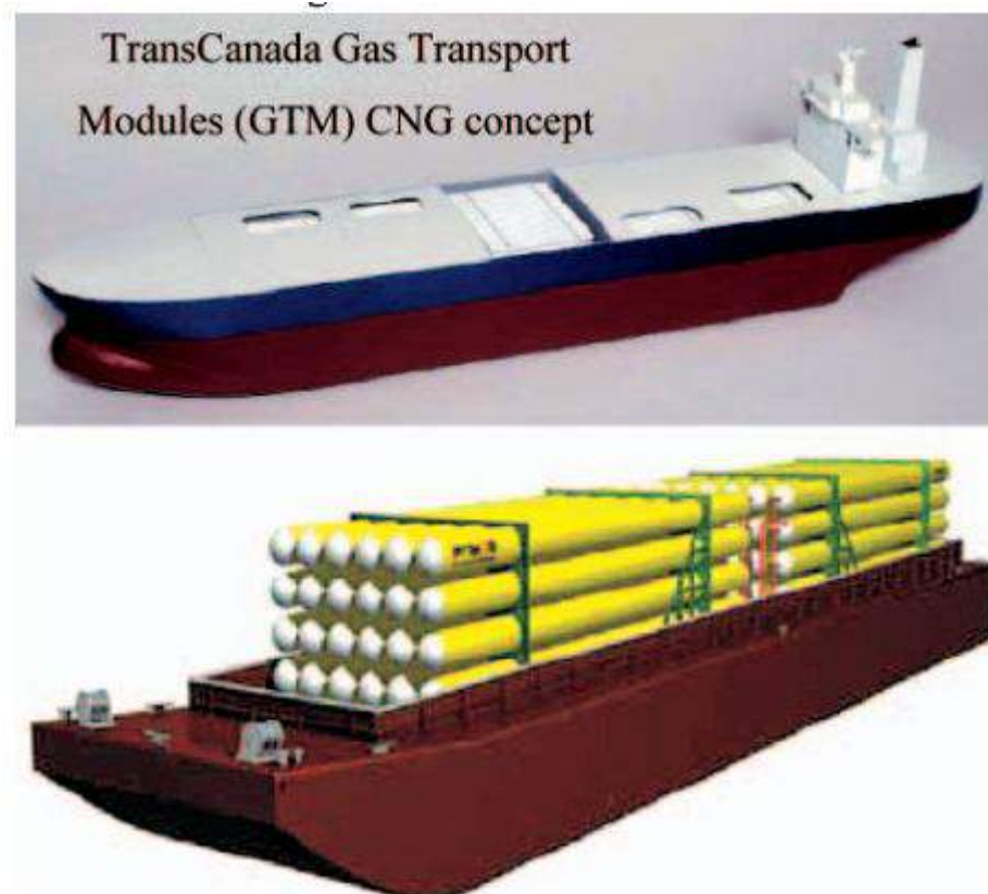
Рисунок 1.13 – CNG судно та баржа з газовими транспортними модулями за технологією компанії TransCanada CNG Technologies
