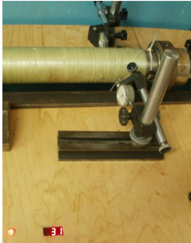
Рисунок 5.7 – Визначення радіальної деформації моделі лінійної ділянки рухомого трубопроводу
