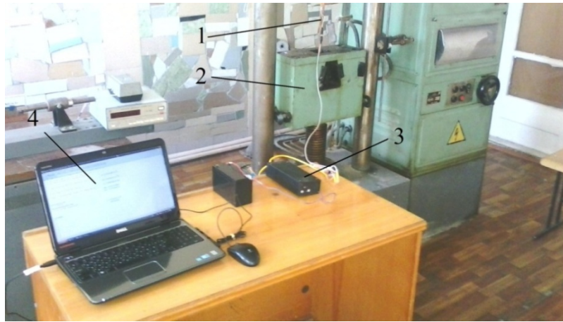
1 – фрагмент моделі трубної колони; 2 – розривна машина Р-20; 3 – аналого-цифровий перетворювач (АЦП); 4 – персональний комп'ютер
