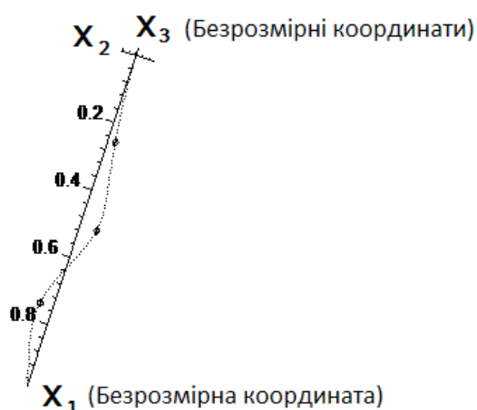
Рисунок 5.17 – Пружна вісь колони насосно-компресорних труб у просторово викривленій ділянці свердловини
