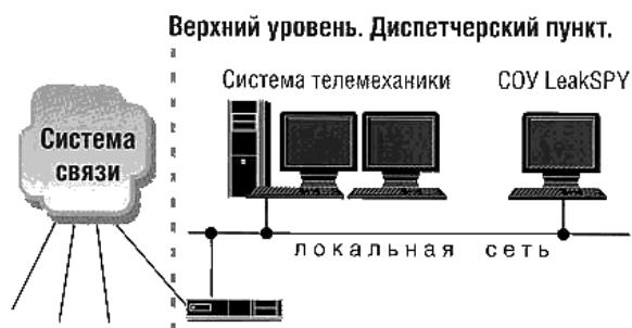
Рисунок 4.5 – Структурна схема системи моніторингу трубопроводу з застосуванням СВВ «LeakSPY»
