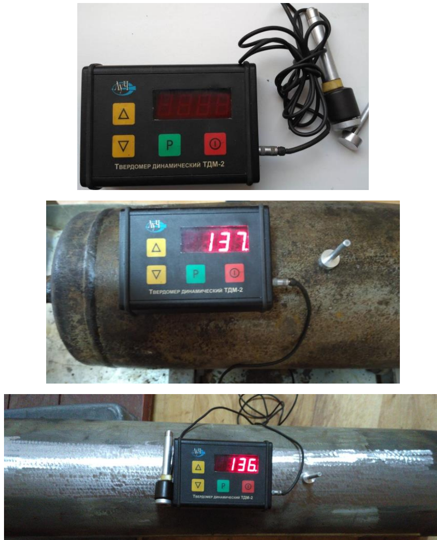
Рисунок 3.17 – Вимірювання твердості металу приладом ТДМ-2
