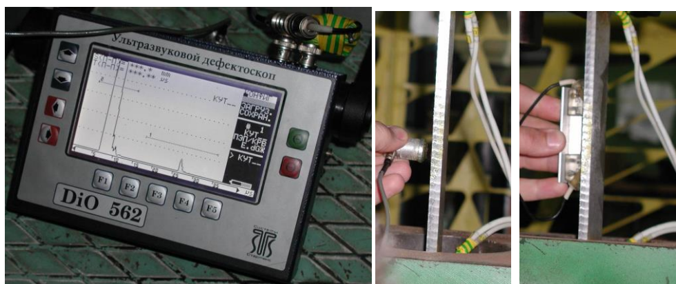
Рисунок 3.6 – Загальний вигляд ультразвукового дефектоскопа DIO 562 (а) і способи вимірювання швидкості поширення ультразвукових хвиль (б)
