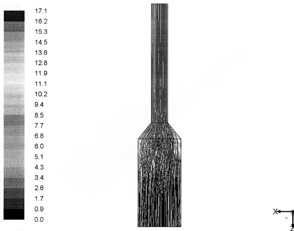
Рис. 6.40. Линии тока газа, окрашенные в соответствии с временем его пребывания, с (вариант № 3, вид снизу)
