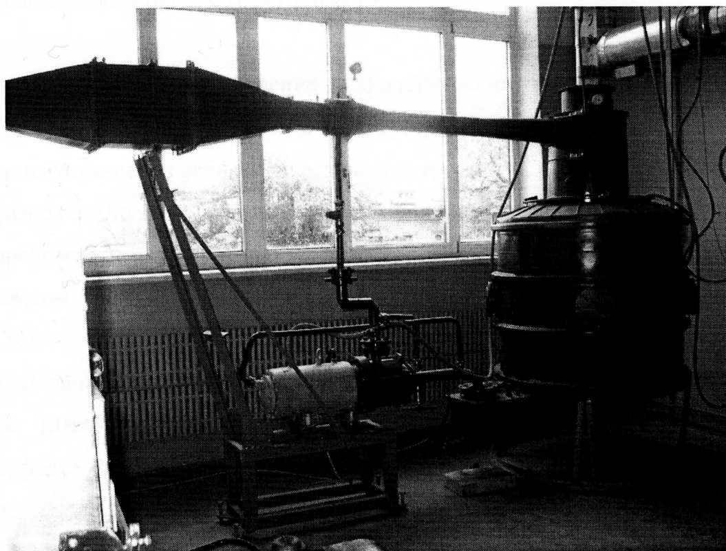
Рис. 5.17. Установка очистки газа
