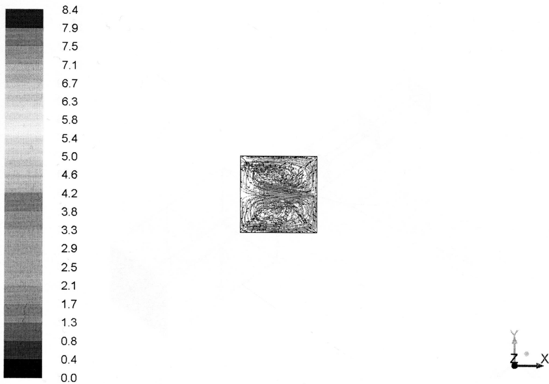
Рис. 6.29. Линии тока газа, окрашенные в соответствии с временем его пребывания, с (вариант № 2, вид спереди)
