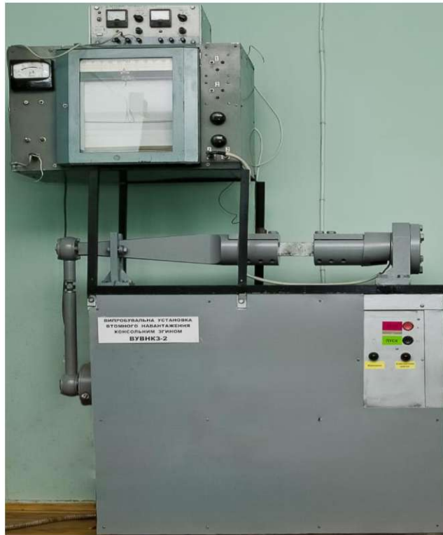
Рисунок 2.5 – Загальний вигляд експериментальної установки для дослідження закономірностей розвитку втомної чи корозійно-втомної тріщини в трубопровідних сталях при асиметричному втомному навантаженні
