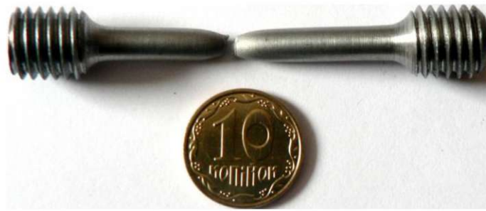
Рисунок 2.4 – Загальний вигляд зразка зі сталі 17Г1С після випробувань
