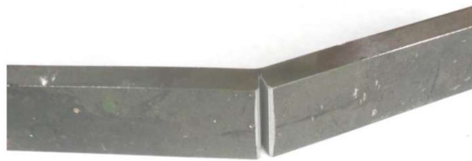
Рисунок 3.6 – Зразок для визначення характеристик критичної тріщиностійкості металу магістральних газопроводів “Київ – Західна Україна І нитка”
