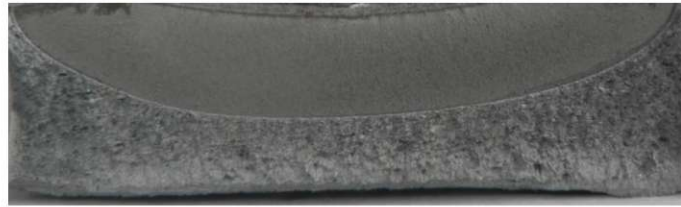
Рисунок 3.7 – Поперечний переріз зразка, вирізаний з труби магістрального газопроводу “Київ – Західна Україна І нитка” з утвореною півеліптичною тріщиною після проведення експерименту
