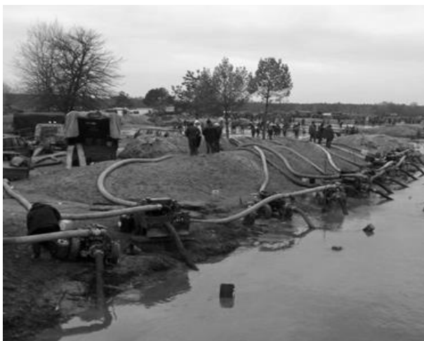
Рис. 2. Гідромеханічний спосіб видобутку бурштину
