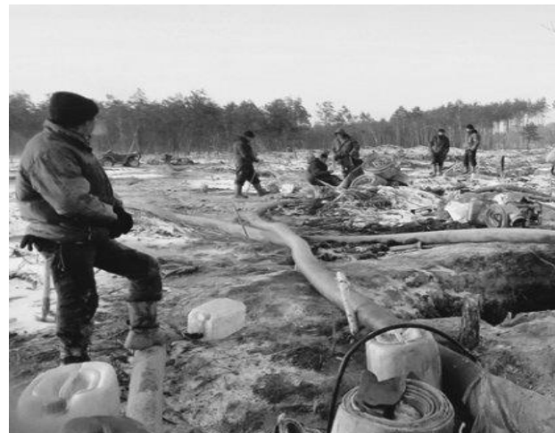
Рис. 2. Гідромеханічний спосіб видобутку бурштину
