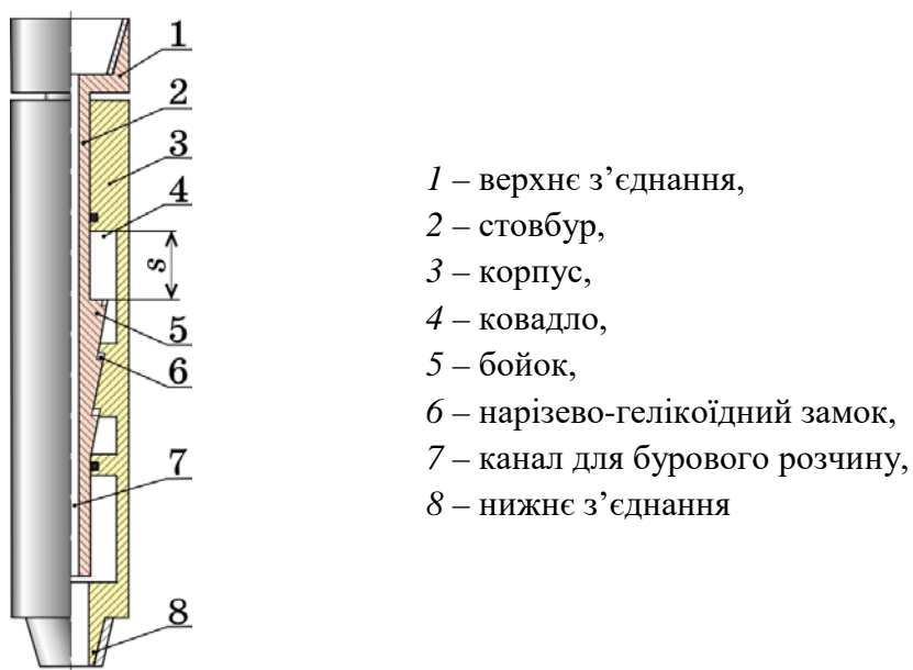
Рисунок Д.18 – Збудник пружних коливань
