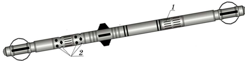
Рисунок Д.3 – Акустичний цементовимірювач: 1 – випромінювач, 2 – приймачі
