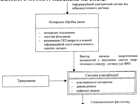
Рисунок 2 – Схема універсальної автоматичної системи визначення фазового складу багатofазового потоку в трубопроводі
