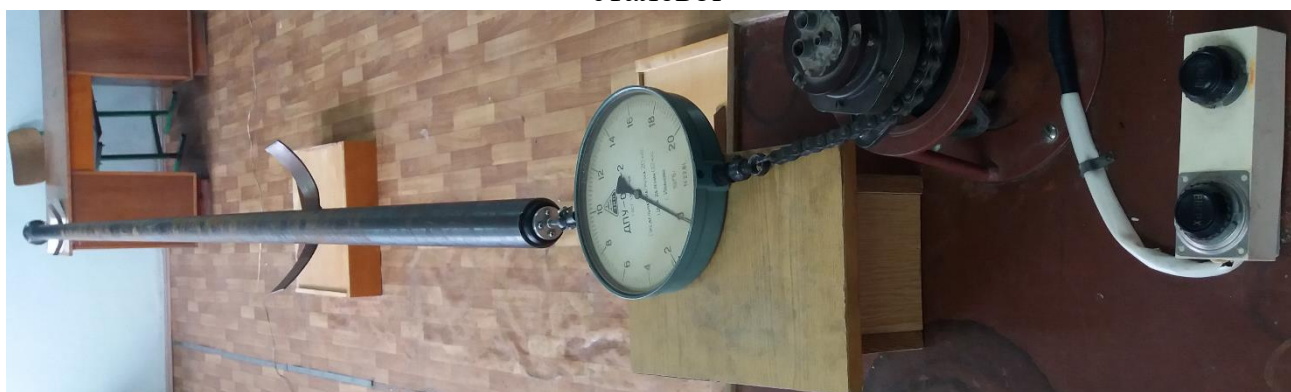
Рисунок 3.3 – Експериментальне визначення сили тертя манжет поршня до стінок зношеної сталевій труби
