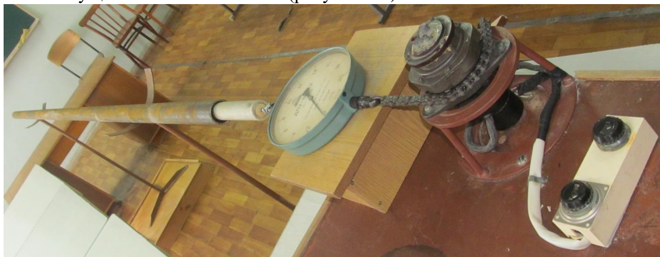
Рисунок 3.2 – Експериментальне визначення сили тертя поліетиленової труби до сталевій
