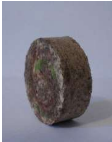
Рисунок 4.24 – Фото брикету, отриманого методом формування під високим надлишковим тиском, до експерименту з визначенням динамічної міцності
