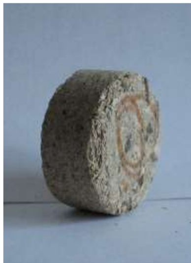
Рисунок 4.25 – Фото брикету, отриманого методом формування під високим надлишковим тиском, після експерименту з визначенням динамічної міцності
