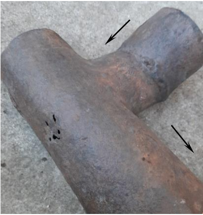
Рисунок 15 – Трійник тепломережі з наскрізними дефектами та результати моделювання його ерозійного зношування
