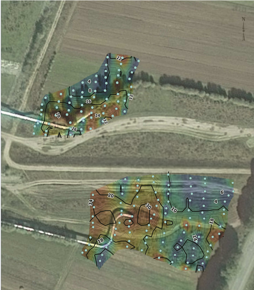
Рисунок 4.13 – Інтенсивність випромінювання електромагнітного поля Землі, масштаб 1:1000, напрям антени Y
