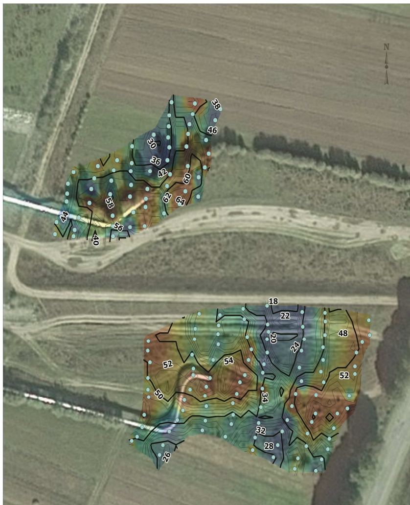
Рисунок 4.15 – Інтенсивність випромінювання електромагнітного поля Землі, масштаб 1:1000, повний вектор напруження T
