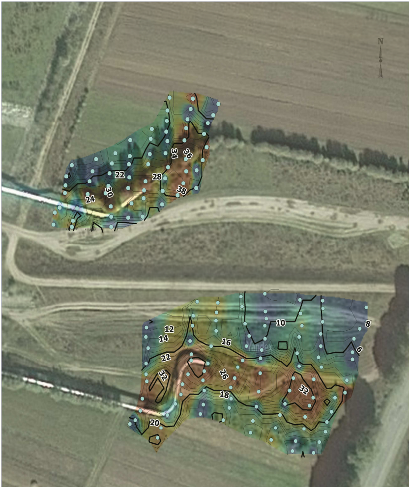
Рисунок 4.14 – Інтенсивність випромінювання електромагнітного поля Землі, масштаб 1:1000, напрям антени Z
