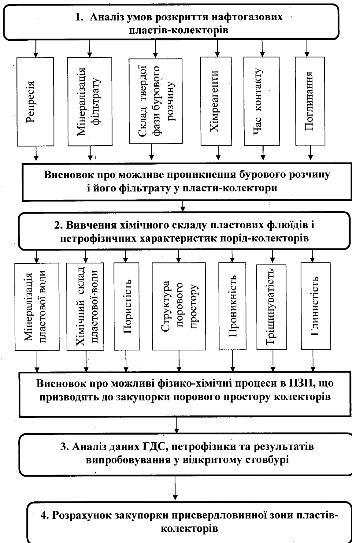
Рис.4.25. Методика прогнозу закупорки порід-колекторів у присвердловинній зоні
