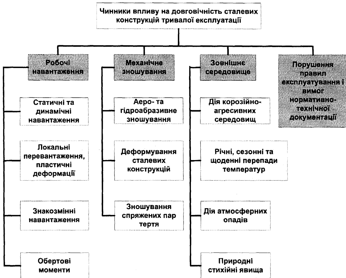
Рис.1.1. Чинники, що впливають на довговічність сталевих конструкцій тривалої експлуатації
