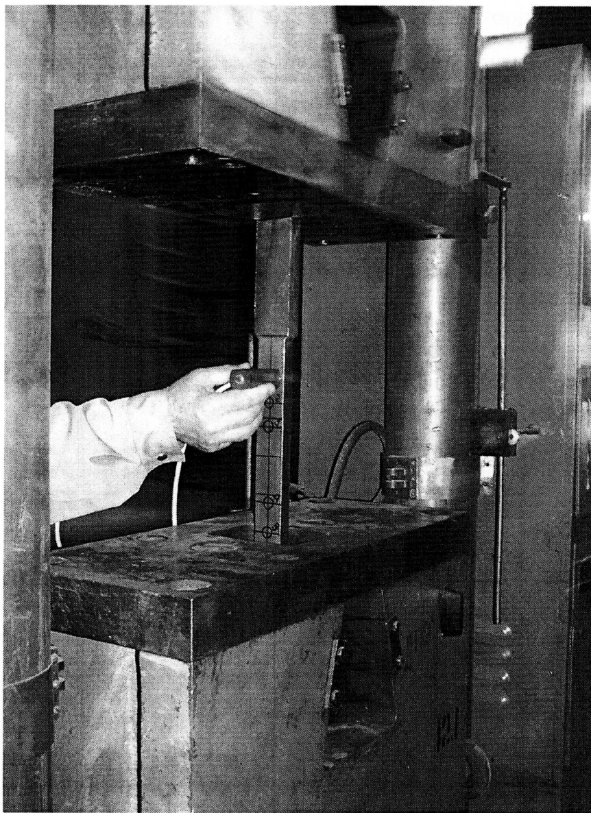
Рис. 4.4. Тарування зразка на розривній машині
