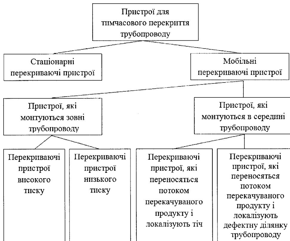
Рис. 1.2. Класифікація перекриваючих пристроїв
