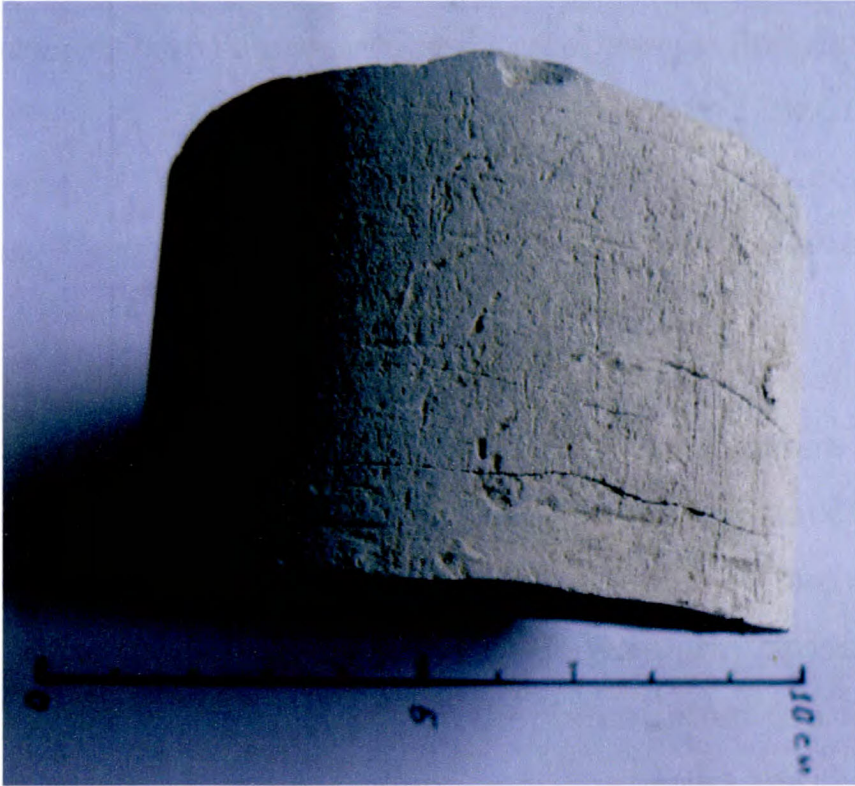
Рис.3.11. Зразок керна розділяється на пластини («п'ятаки») по площинах літогенетичних тріщин вздовж нашарування. Сverdловина 7-Микуличин, інтервал 2226-2234 м (горизонт клівських пісковиків).
