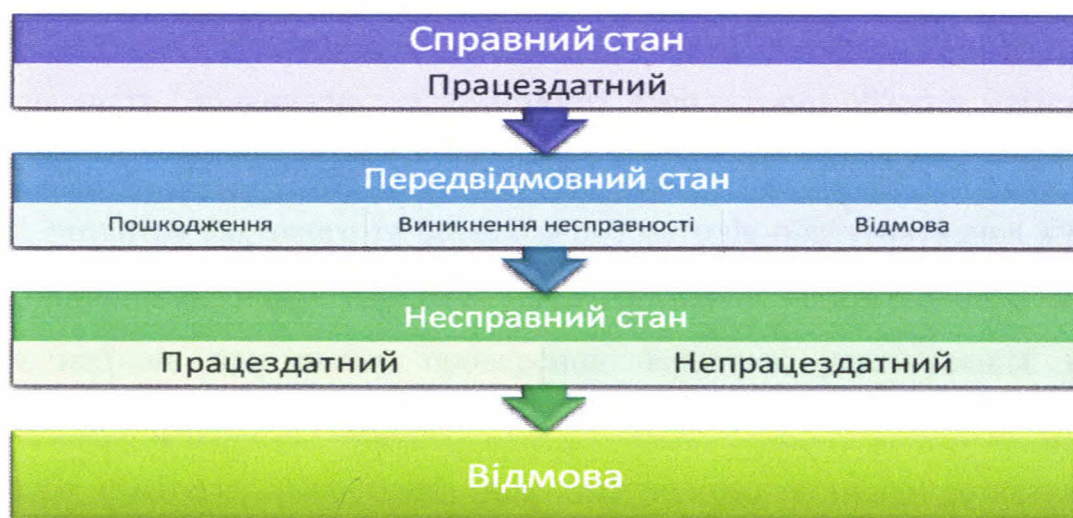
Рисунок 2.4 – Схема переходів БКУ та його елементів зі справного в несправний стан
