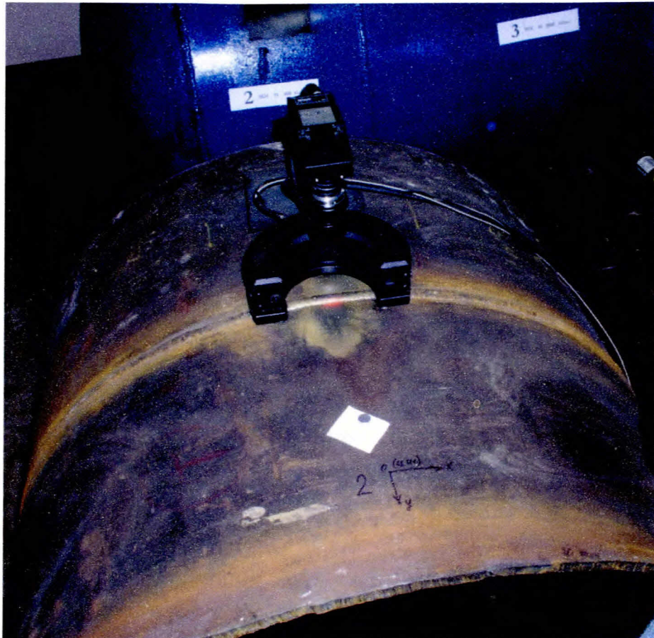
Рис. 4.10. Визначення залишкових напружень в зоні кільцевого зварного шва на зовнішній поверхні дослідної котушки
