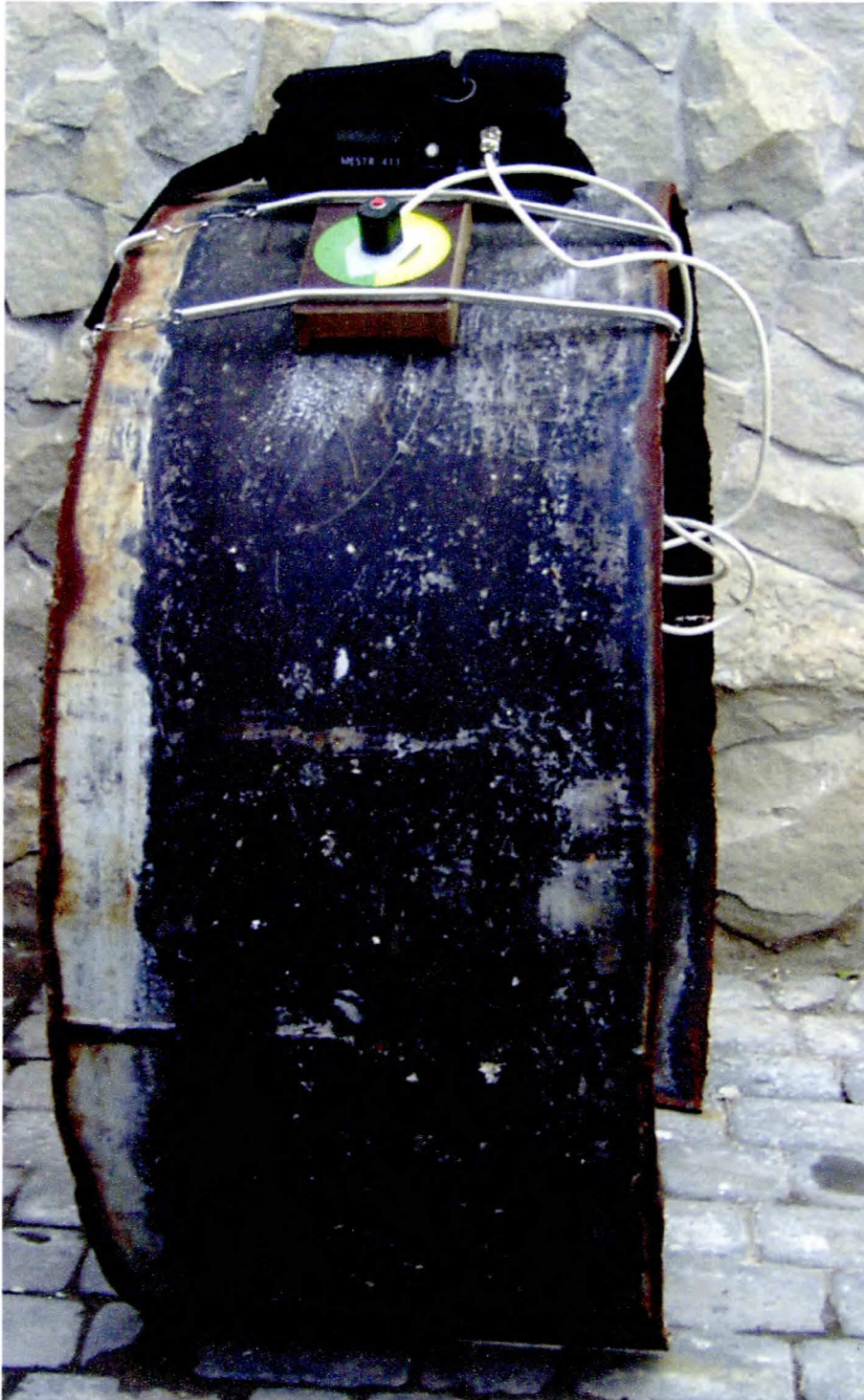
Рис. 4.15. Урахування впливу структури металу труби на початкові покази вимірювань приладу „MESTR - 411”
