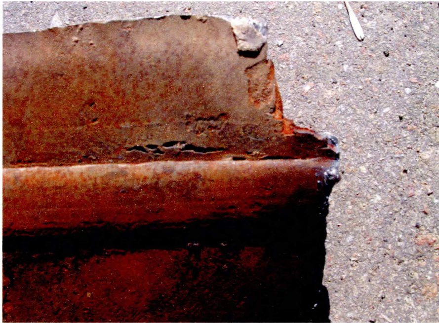
Рис. 1.1. Утворення тріщин в пришовній зоні поздовжнього зварного шва труби
