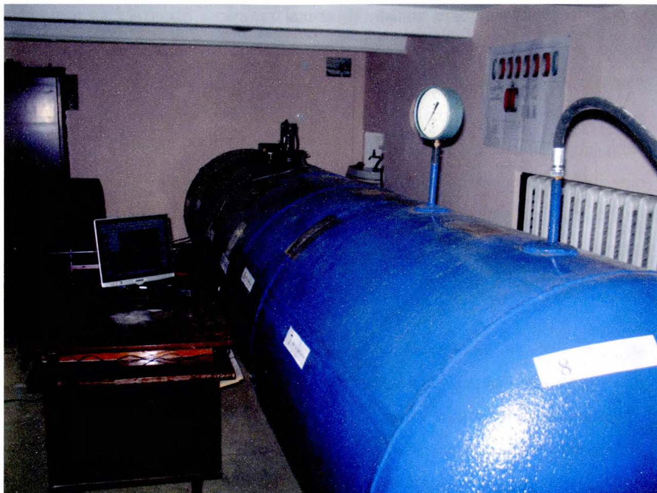
Рис. 4.5. Установка для моделювання НДС в зоні різнотовщинних зварних з'єднань трубопроводів
