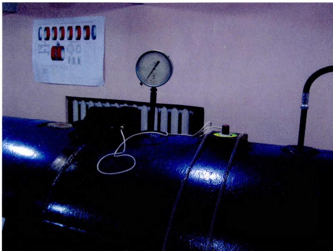
Рис. 4.14. Тарування вимірювального тракту приладу «MESTR -411» на експериментальній установці
