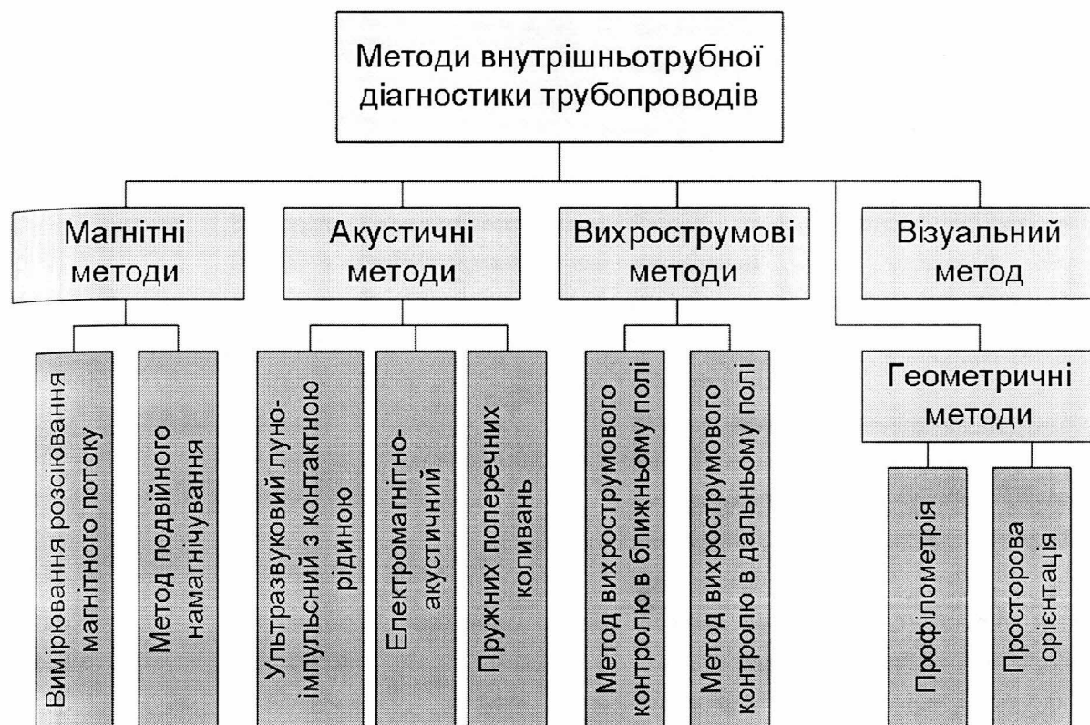
Рисунок 1.12 Методи внутрішньотрубної діагностики магістральних трубопроводів
