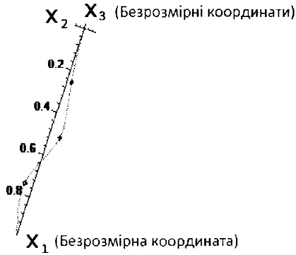
Рисунок 19 – Пружна вісь колони насосно-компресорних труб у просторово викривленій ділянці свердловини
