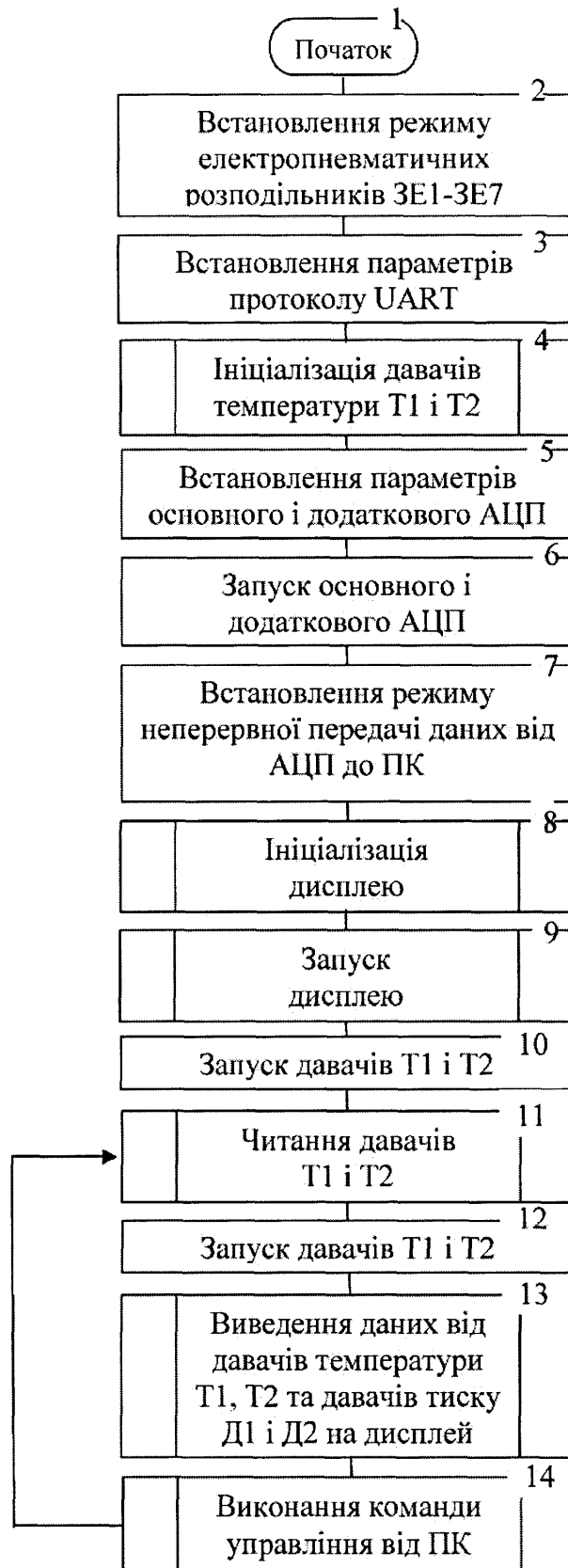
Рис. 3.4. Блок-схема алгоритму програмного коду мікроконтролера ADUC834
