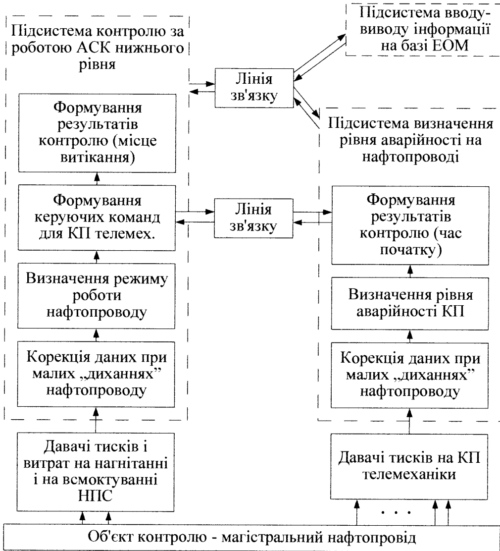
Рис. 3.3. Структура автоматизованої системи контролю виявлення витоку або несанкціонованого відбору нафти з МН
