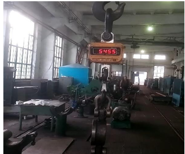
Рисунок 4.26 – Згвинчування із навантаженням понад 5455 кг (56947 Нм)
