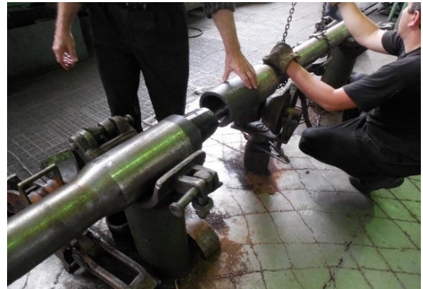
Рисунок 4.24 – Нанесення мастильного матеріалу на поверхню різьби ніпельної та муфтової частин
