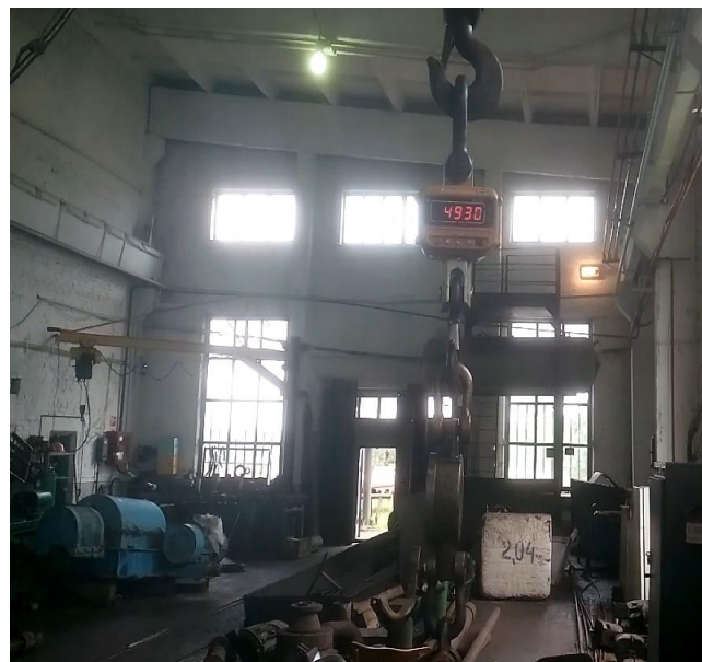
Рисунок 4.27 – Момент розгвинчування з навантаженням понад 4900 кг (51675 Нм)
