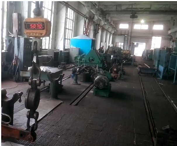
Рисунок 4.25 – Згвинчування із навантаженням понад 5070 кг (53467 Нм)
