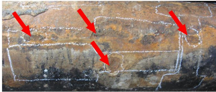
Рисунок 2.4 – Ділянка нафтопроводу із локальними корозійними дефектами
