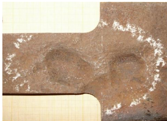
Рисунок 4.8 – Зразок з локальними ерозійними дефектами
