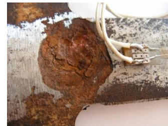
Рисунок 2.4 – Ділянка нафтопроводу із локальними корозійними дефектами
