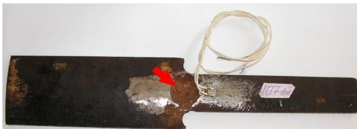
Рисунок 2.4 – Ділянка нафтопроводу із локальними корозійними дефектами
