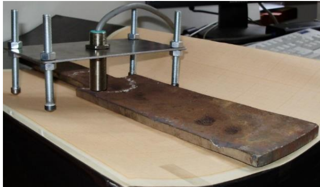
Рисунок 4.9 – Стенд для сканування дефектів на внутрішній поверхні зразка
