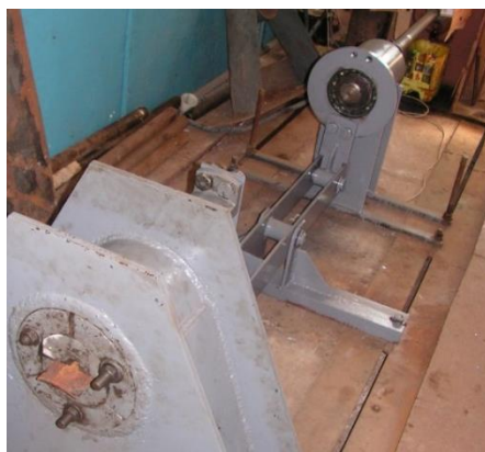
Рисунок 2.8 – Загальний вигляд установки для проведення втомних досліджень моделей-“вирізків”
