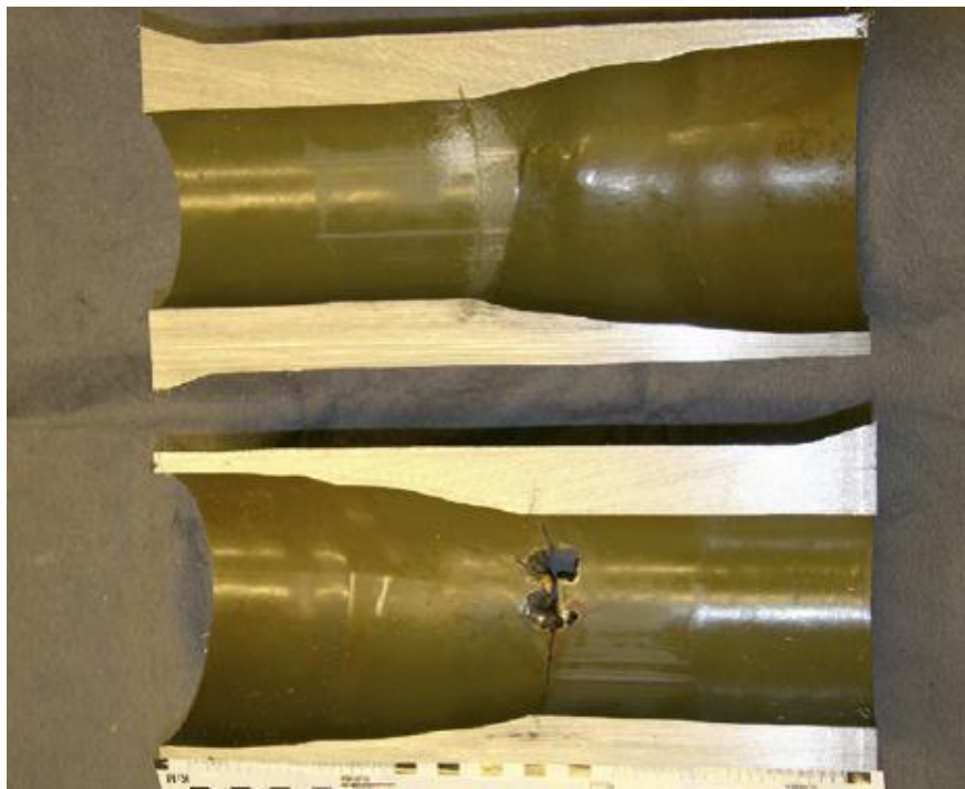
Рисунок 1.9 – Промивина і втомна тріщина при внутрішньому руйнуванні [193]
