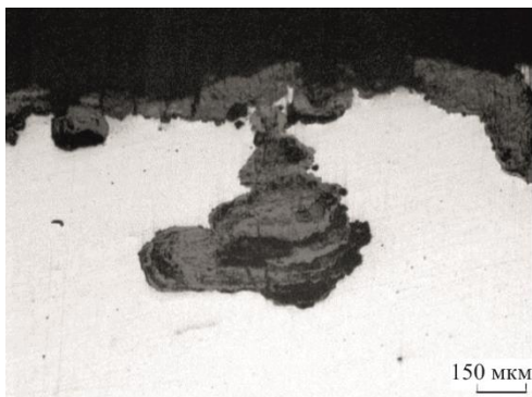
Рисунок 1.12 – Морфологія корозійної виразки на внутрішній поверхні вимивного отвору [180]
