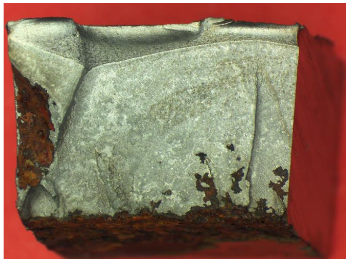
Рисунок 1.25 – Поверхня руйнування вимушеної розкритої тріщини [184]
