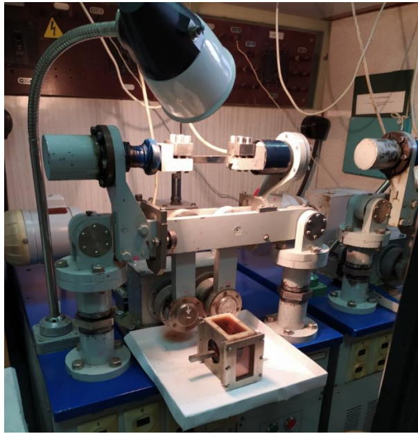
Рисунок 2.12– Дослідна машина для випробовування призматичних зразків на чистий згин в умовах втомного навантаження і корозивних середовищ
