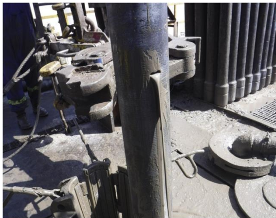
Рисунок 1.17 – Промив 127 мм БТ (тріщина поширюється радіально) [150]
