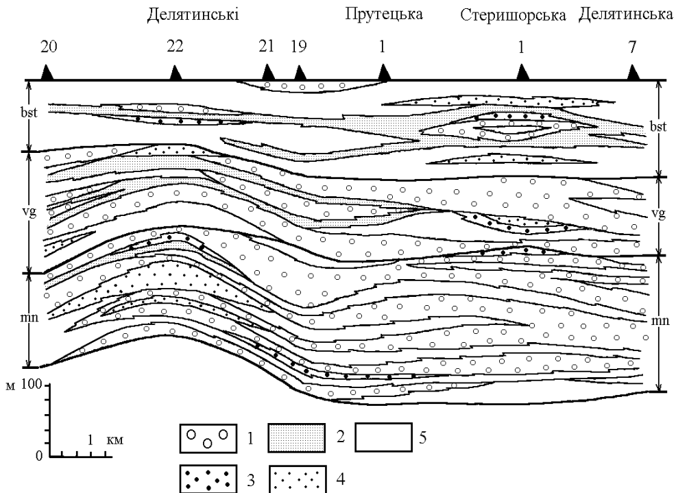
Літміти: 1 – істотно псамітовий; 2 – змішаний (аргіліт, алеврит, псаміт); 3 – істотно алевритовий; 4 – алевро-псамітовий, псамо-алевритовий; 5 – істотно глинистий.
