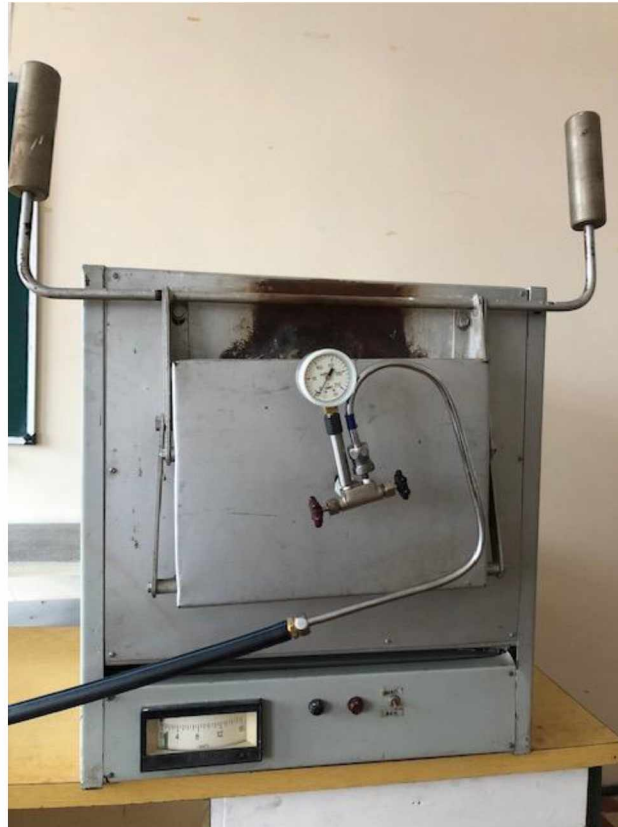
Рисунок 2.6 – Пристрій для отримання біосорбенту
