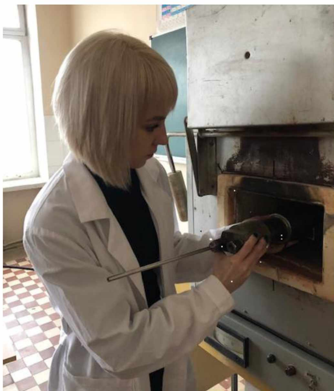
Рисунок 5.2 – Завантаження металевого реактора в установку
