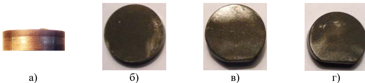
а), б) – нова; в) – з довжиною хорди зношення 5,0 мм; г) – з довжиною хорди зношення 8,0 мм
