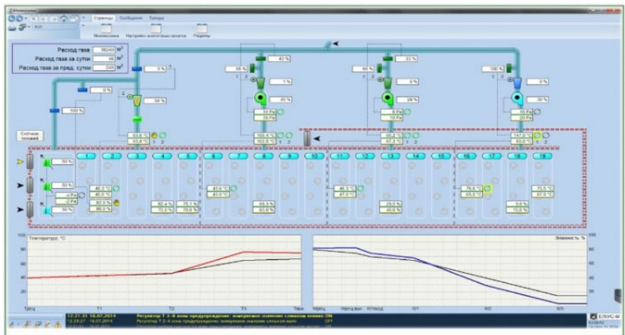
Рисунок 1.12 – Автоматизована система підготовки сировини фірми «Еліус-М» [9].
