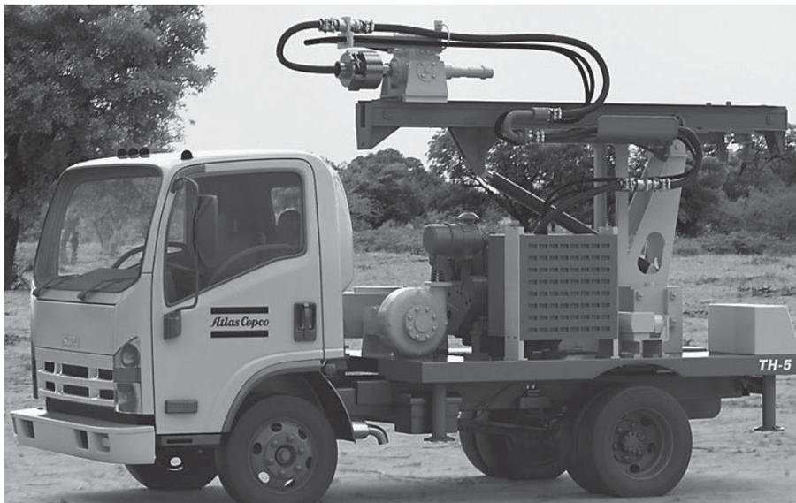
Рисунок 2.11 - Буровая установка TH5
