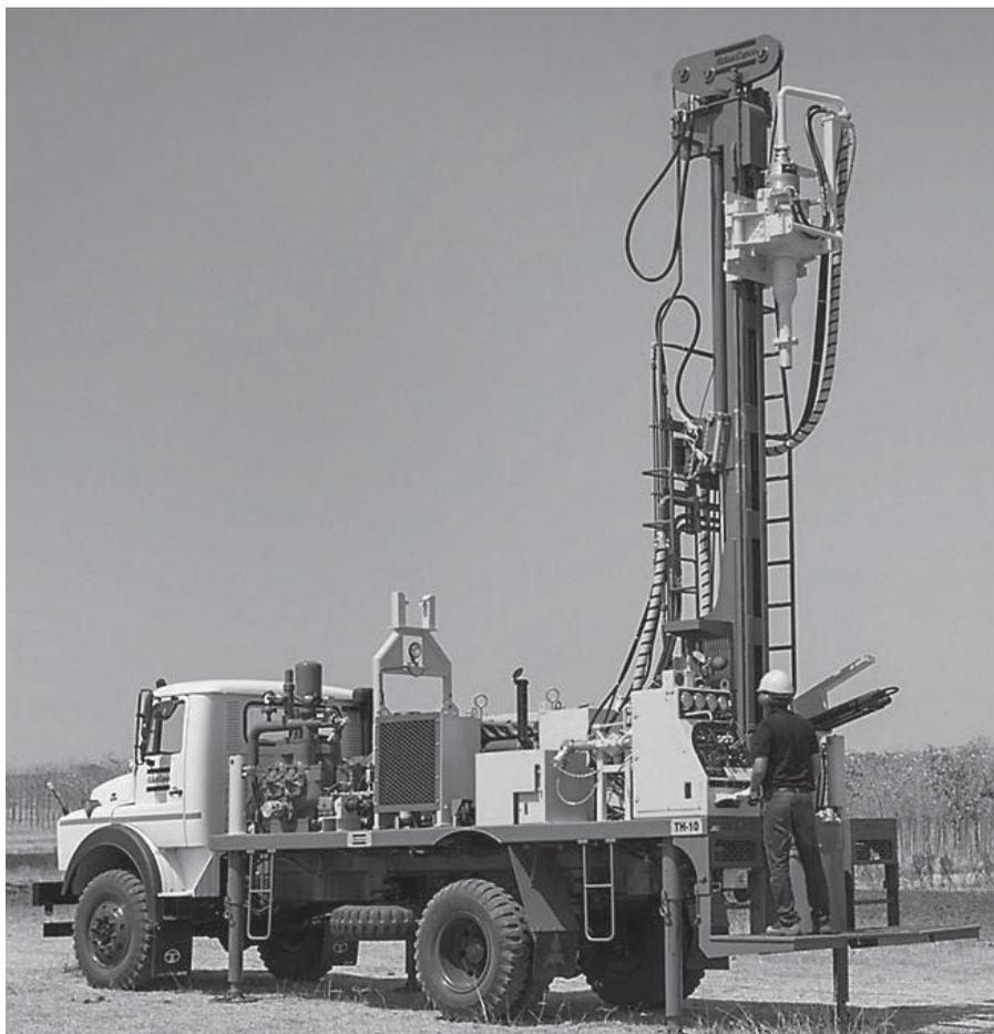
Рисунок 2.12 - Буровая установка TH10
