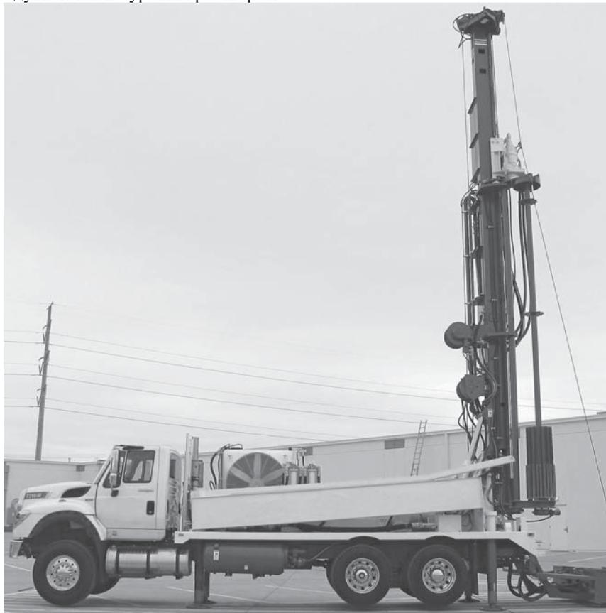
Рисунок 2.13 - Буровая установка T2W
