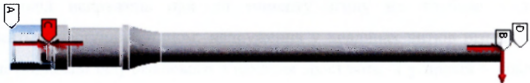
Рисунок 4.2 – Схема навантажування різьбового з'єднання
