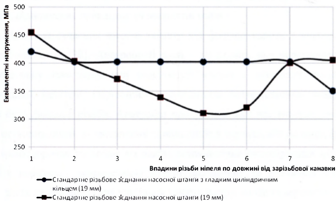
Рисунок 5.7 – Розподіл еквівалентних напружень по впадинах різьби
