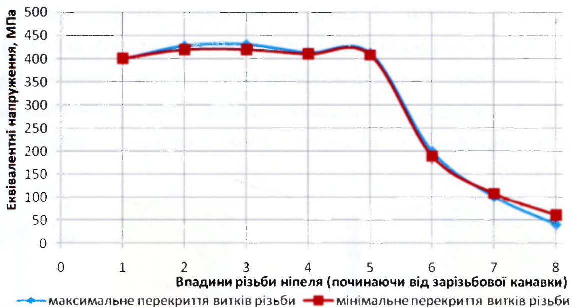
Рисунок 3.11 – Розподіл еквівалентних напружень (за Мізесом) по впадинах різьби ніпеля зношеної різьби насосної штанги діаметром 19 мм
