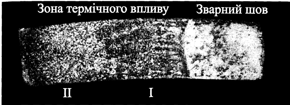
Рис. 3.10. Макробудова зварного з'єднання (поздовжній шліф)
