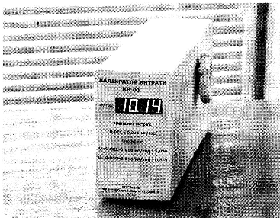
Рис. 4.5. Задатчик мікровитрат для перевірки витратомірів газу в діапазоні від 0,001 \text{ м}^3/\text{год} до 0,016 \text{ м}^3/\text{год}
